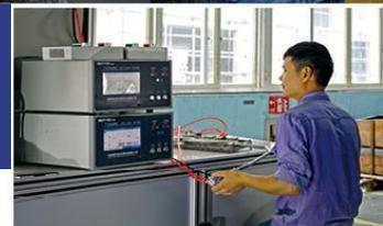
差压式气密检测仪
