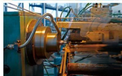
数控八工位管端加工机
